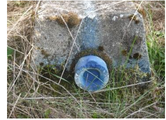
Figure 4 Repère de nivellement
